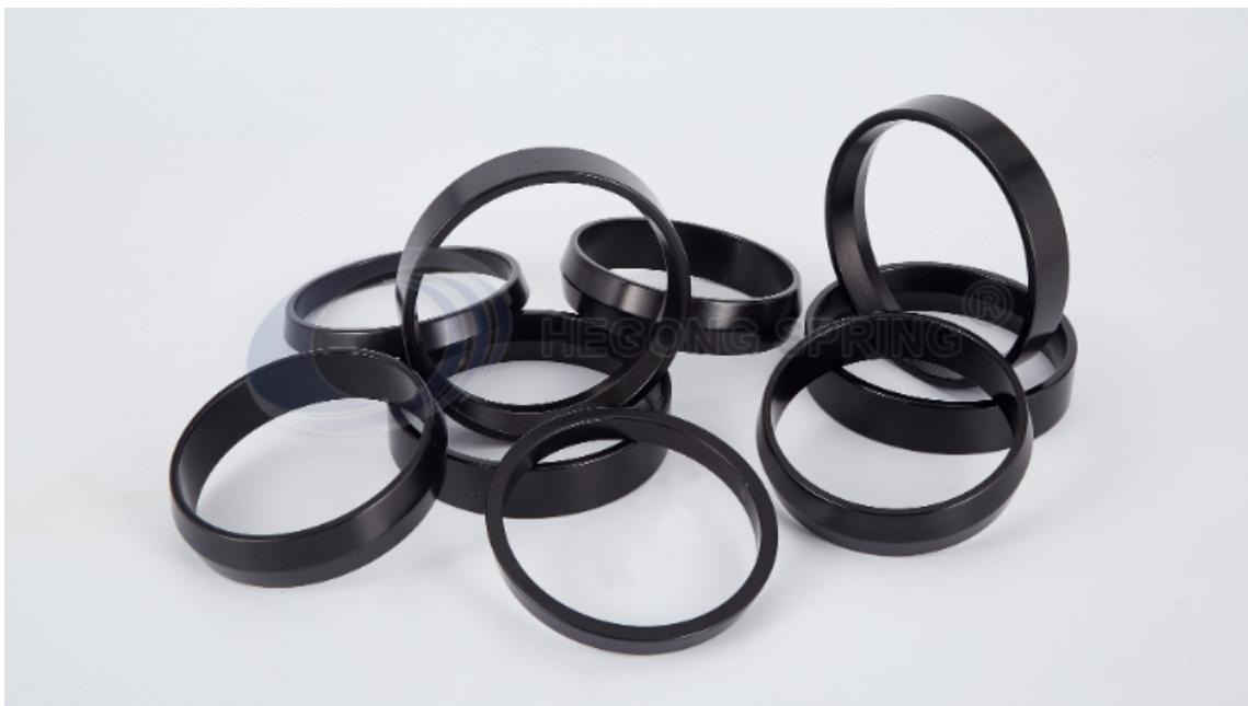
环形弹簧的选型：环形弹簧主要应用于由温度和压力波动（或梯度）引起的经常性泄漏或者密封要求高的阀门，低速旋转设备上的轴承，设备和管道法兰。
